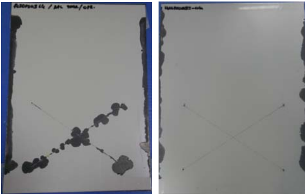
Şekil 6. 500 saat korozyona zorlanmış iki PPG numune paneli
