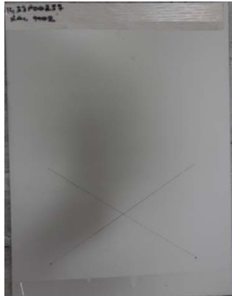
Şekil 4. NSSF testi için hazırlanmış bir PPG numune paneli
