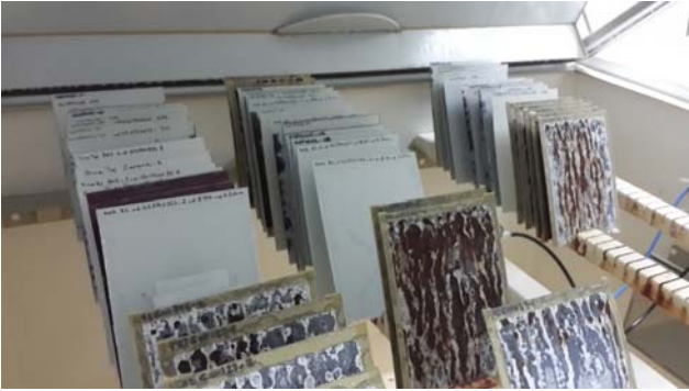
Şekil 5. Korozyon kabineye yerleştirilmiş numuneler
