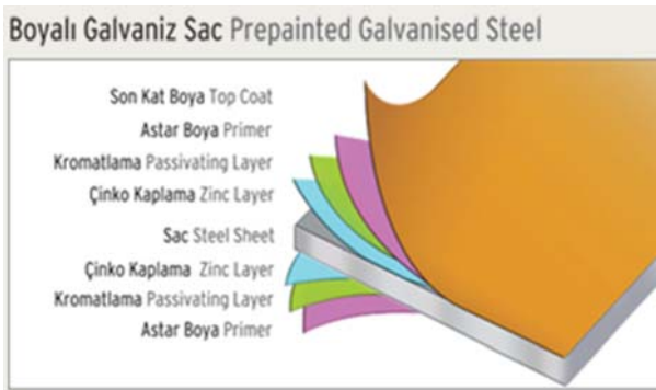
Şekil 1. PPG Sac katmanları
